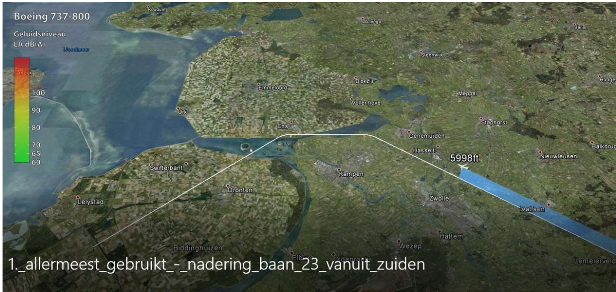
Figuur 14: Allermeeest-gebruikte nadering baan 23; 6000 voet ter hoogte van Zwolle; daling naar 3000 voet wordt ingezet.
